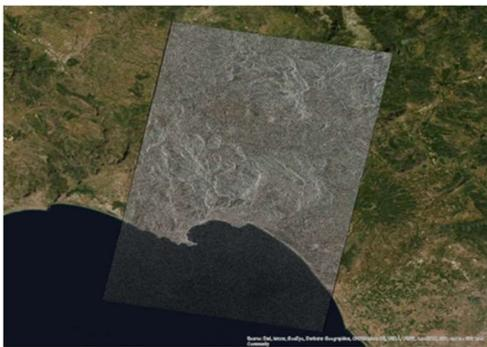
ASTERRA prende i dati "grezzi" e li prepara per l'analisi, filtrando rimbalzi di edifici e altri oggetti artificiali, vegetazione, corsi d'acqua e reticoli idrici che potrebbero generare interferenze con la rilevazione delle perdite idriche.
